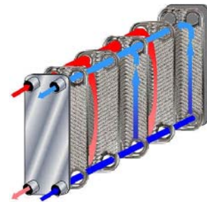
Durch grosse Übertragungsflächen bei kompakten Aussenabmessungen werden hohe Kühlleistungen erreicht.
